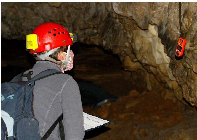
Slika 5. Mjerenje i bilježenje mikroklimatskih značajki uređajem Kestrel 4000 Pocket Weather Tracker
